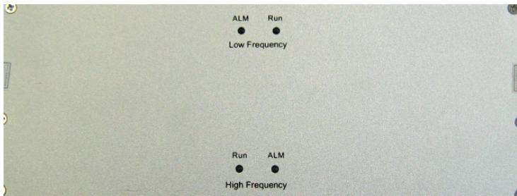
На передней панели устройства находятся: индикаторы включения (Run) и уровня сигнала (ALM) диапазонов низкой (Low) и высокой (High) частоты.
