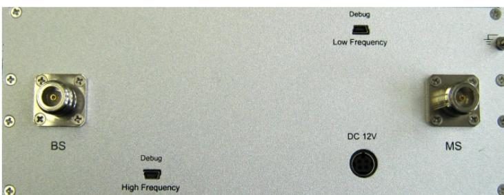
На задней панели находятся: входной разъем (BS), выходной разъем (MS), разъемы для подключения компьютера для диапазонов низкой (Low) и высокой (High) частоты и разъем для подсоединения адаптера питания (DC 12V).
