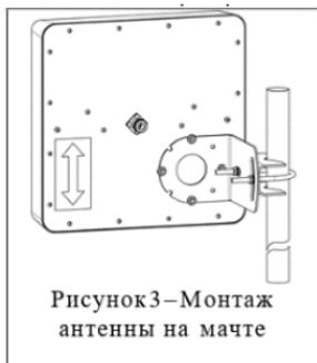
Рисунок 3 – Монтаж антенны на мачте
